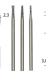
NO 28 758 Hög måttnoggrannhet ger vibrationsfri fräsning. Arbetsstycket måste vara ordentligt inspant för att undvika förskjutningar. Bearbetning av metall (icke järnmetall) och plast samt andra hårda material. Lämpligt för gravering, urfräsning av halvledarplattor. Alla skaft \varnothing 2,35 eller 3,0. Vi rekommenderar att man använder MICROMOT-stålspannhylsor.
