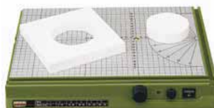
För cirkelsnitt finns det en enkel och effektiv lösning. Tejpa fast ett häftstift så fungerar den som vridningspunkt.
